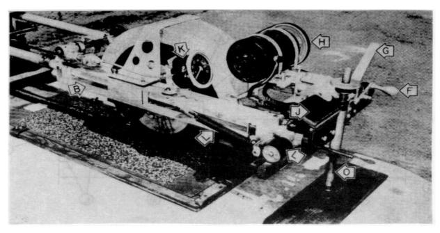
FIGURE 2 - SIDE VIEW OF SKID TESTER
